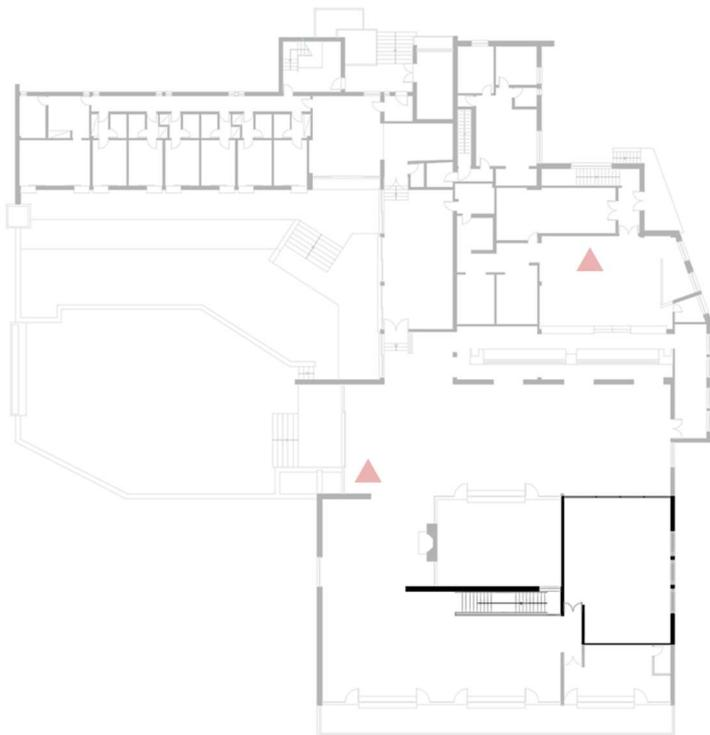
Figura 50 – Localização dos extintores existentes no piso 1
