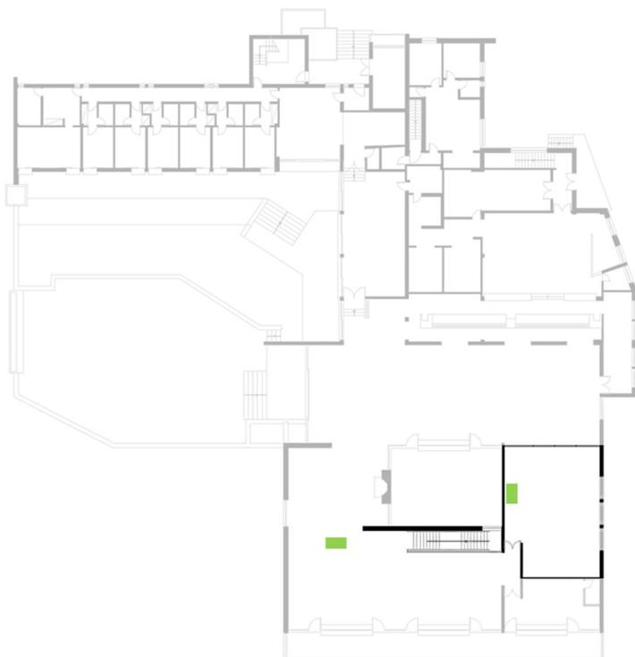
Figura 45 – Iluminação de emergência no LR e na via de evacuação horizontal no piso 1
