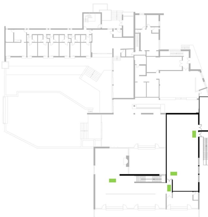
Figura 66 – Iluminação de emergência no piso 1
