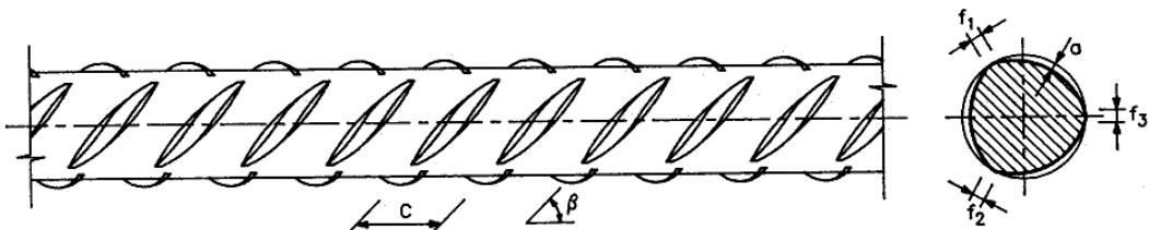
Figura 6 – Perfil nervurado dos varões do tipo A500 ER
