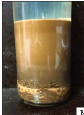
FIG. 6 – À esquerda, ensaio de sedimentação rápida às três amostras de terra (ANDRADE, 2019).
