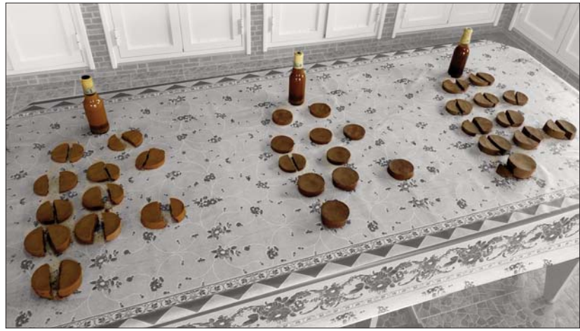
FIG. 7 – À direita, ensaio das pastilhas (após cortes) às três amostras de terra (ANDRADE, 2019).
