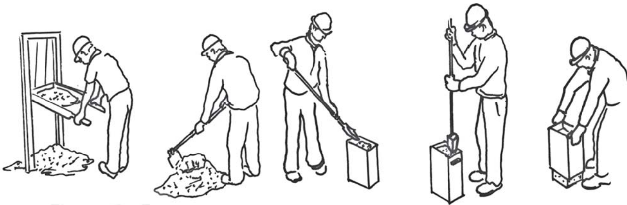
FIG. 6 – Fases do fabrico de adobes.
