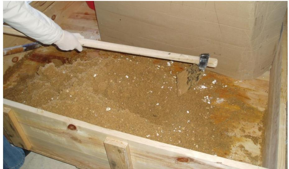
Temperaturas elevadas favorecem a reação com os agregados e um aumento da resistência. Mas é um processo com muitos riscos. Talvez adequado para alvenarias.
