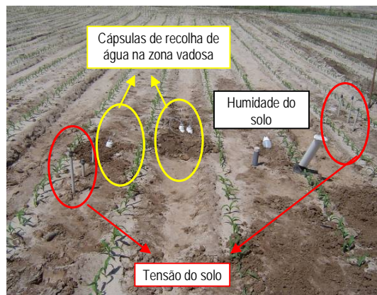
Figura 2 • Instalações experimentais de campo
