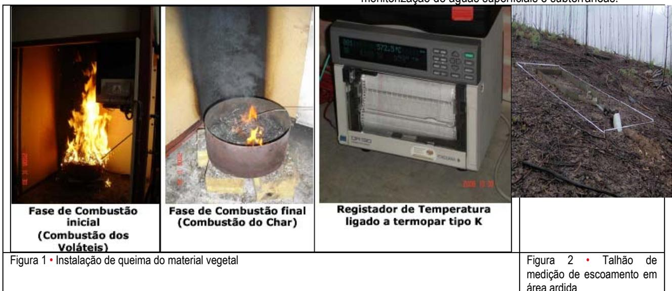
Figura 1 • Instalação de queima do material vegetal
