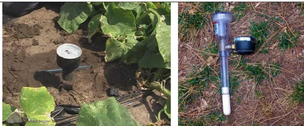
Fig. A.15. Tensiómetro para condução da rega
