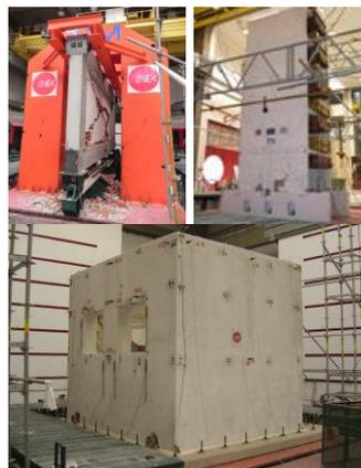
Ensaio sísmico de avaliação experimental e desenvolvimento assistido de sistemas passivos e semi-ativos de mitigação das solicitações sísmicas nas estruturas.
