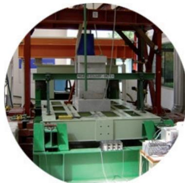
Ensaio sísmico de avaliação experimental e desenvolvimento assistido de sistemas passivos e semi-ativos de mitigação das solicitações sísmicas nas estruturas.
