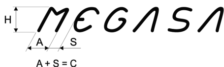
Figura 4 – Parâmetros geométricos da inscrição “MEGASA” nos varões MEGASA 500SD – ZARAGOZA
