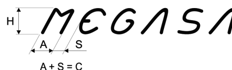
Figura 4 – Parâmetros geométricos da inscrição "MEGASA" nos varões MEGASA 500SD E – SEIXAL
