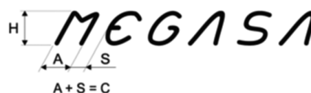
Figura 4 – Parâmetros geométricos da inscrição “MEGASA” nos varões MEGASA 500SD – MAIA
