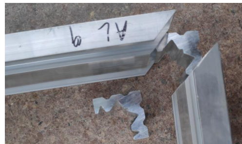
Figura 2 – Ligação dos perfis nos cantos do esquadro de alumínio que constitui a periferia do painel (pormenor de um canto, antes da cravação da cantoneira)
