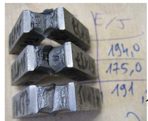
Détail de l'éprouvette bi-appuyée
