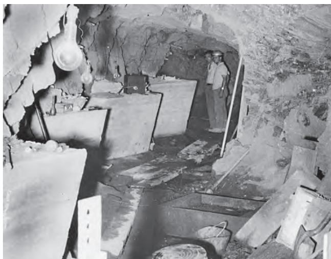
Ensaio de corte de rocha e preparação de um conjunto de quatro ensaios. Rock shear strength test and setup for a set of four tests.
