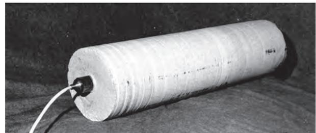
procedimento de ensaio, nomeadamente a ligação entre a rocha e o cilindro de plástico, e também para confirmar que as extensões medidas, sob um estado de tensão conhecido, correspondiam às calculadas analiticamente.
