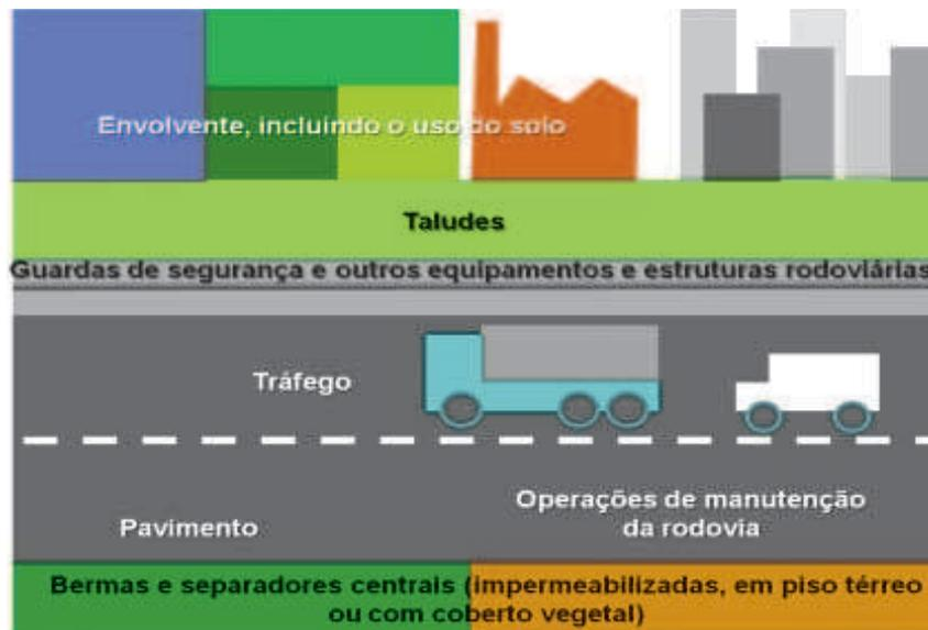
Figura 3 – Esquema das principais origens dos poluentes que integram as águas de escorrência de estradas.
