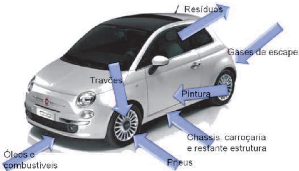
Figura 4 – Esquema com as principais componentes das viaturas que contribuem com poluentes.
