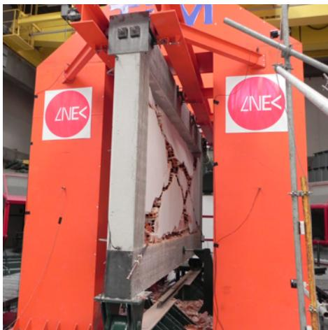
Ensaios sísmicos e avaliação experimental e desenvolvimento assistido de sistemas passivos ou semi-ativos para mitigação das solicitações sísmicas nas estruturas.
