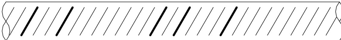
A identificação da origem dos varões e do respetivo fabricante será efetuada através de um código que consiste no engrossamento de certas nervuras conforme se esquematiza na figura acima.
