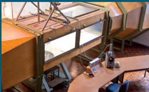
permitindo a variação contínua da velocidade do escoamento de 0 a 16 m/s.
