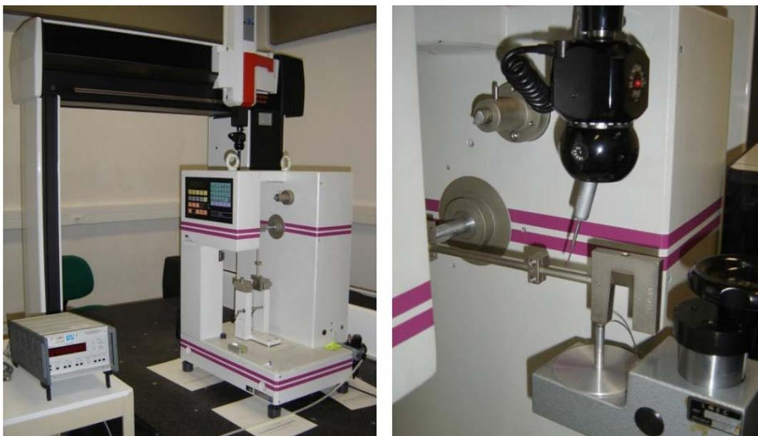
Figura 0-2 Ensaio metrológico de pêndulos de choque Charpy
