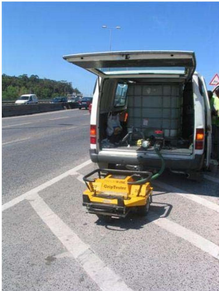
Ensaio com equipamento grip-tester para determinação do coeficiente de atrito em pavimento rodoviário
