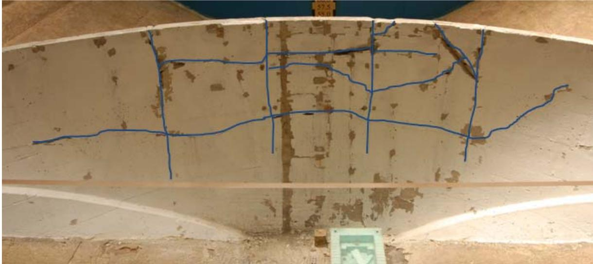
Figura 2-3 – Vista de jusante do modelo após a rotura
