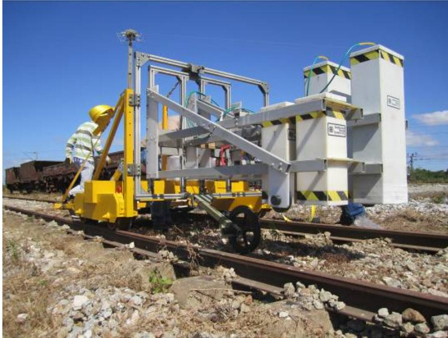
Ensaio com o georadar para caracterização de uma via férrea
