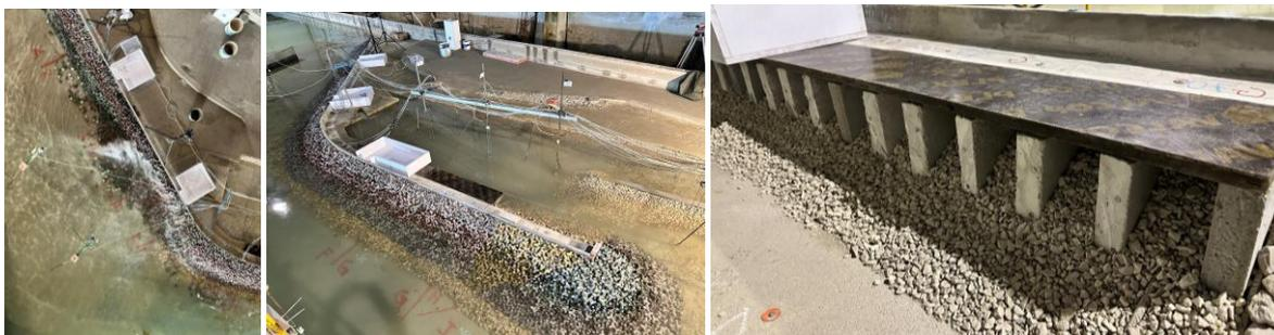
Figura 50 – Modelação física da agitação, estabilidade, galgamentos e das pressões na nova obra de proteção costeira do porto de S. Roque do Pico
