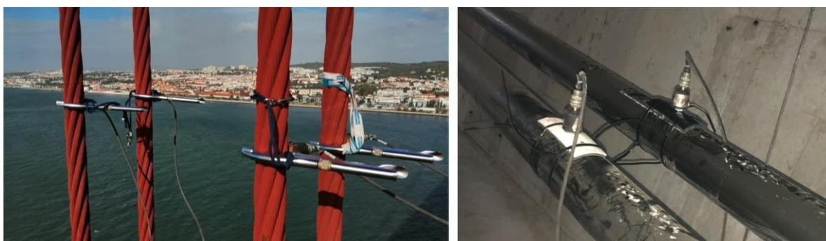
Figura 41 – Medição das forças: a) nos pendurais da Ponte 25 de Abril; b) nos cabos de pré-esforço exterior da Ponte do Freixo
