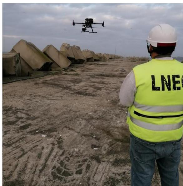
Figura 36 – Levantamento com *drone* do quebra-mar este do porto de Sines
