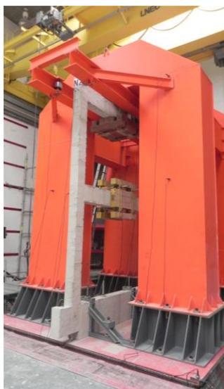
Figura 14 – Ensaio em mesa sísmica de um pórtico plano sem dimensionamento sismo-resistente (projeto AR-SeismicRC)
