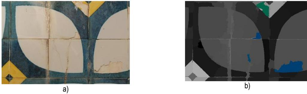
Figura 26 – Azulejos do centro de congressos do LNEC. a) detalhe de uma área de azulejos com lacunas de esmalte, b) imagem representando um índice radiométrico onde os defeitos do esmalte são coloridos em azul e verde.
