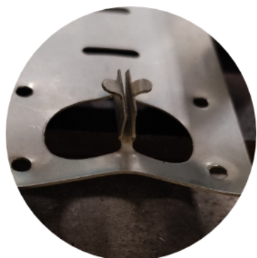
Figura A5.5 – Tipo de rotura do grampo oculto duplo da zona corrente (CRM.04-O) - forças horizontais (vento)
