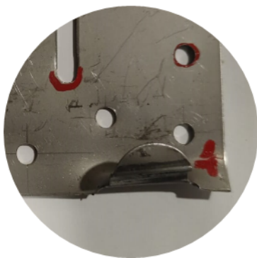
Figura A5.3 – Tipo de rotura do grampo duplo de arranque (CRM.03) - força vertical (peso)
