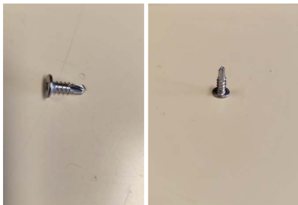
Figura A4.1 – Parafuso auto roscante de cabeça plana A2 STAINLESS STEEL M4.2 × 13 mm
