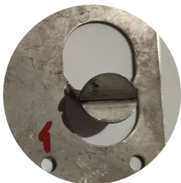
Figura A5.1 – Tipo de rotura do grampo duplo da zona orrente (CRM.04) - força vertical (peso)
