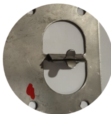
Figura A5.2 – Tipo de rotura do grampo oculto duplo da zona corrente (CRM.04-O) - força vertical (peso)
