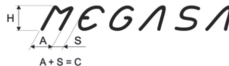
Figura 4 – Parâmetros geométricos da inscrição MEGASA nos varões MEGASA 500SD – SEIXAL
