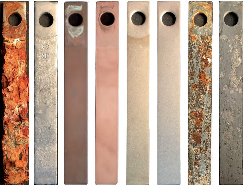
figura 1 | Provetes metálicos avaliados no âmbito de realização do ensaio de corrosividade da água: esquerda - após ensaio; direita - após limpeza dos produtos de corrosão por ataque químico.
