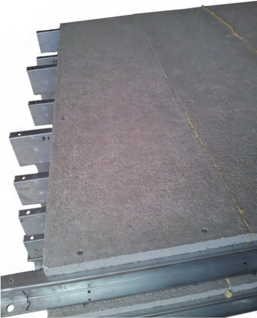
figura 2 | Painéis avaliados no âmbito do ensaio de adequabilidade dos sistemas de proteção à corrosão. Proвете após ensaio com respetivo resultado de análise de imagem.
