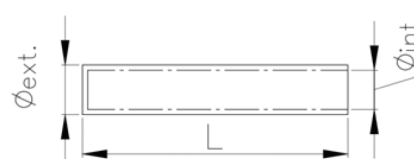
Figura 4 – Características geométricas do perno cilíndrico
