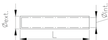
Figura 5 – Características geométricas da manga de PVC
