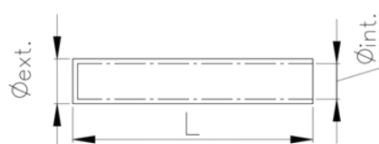
Figure 5 – Caractéristiques géométriques du manchon en PVC
