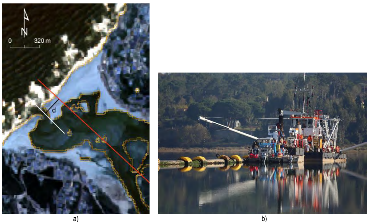
Figura 34 – Dragagens da zona superior da Lagoa de Óbidos: a) aplicação do serviço WORSICA a imagens Sentinel-2 para o estudo da posição da embocadura; b) draga na zona superior da Lagoa de Óbidos.
