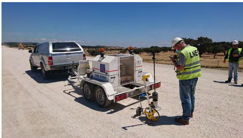
Figura 38 – Ensaios com equipamento FWD sobre a plataforma da via-férrea da nova ligação Évora Norte – Elvas/Caia
