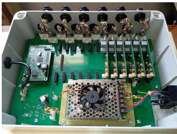
Figura 39 – Sistema de condicionamento de sinal e de aquisição de dados modular para balança aerodinâmica de 6 graus de liberdade
