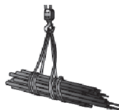
Carga mal acondicionada
