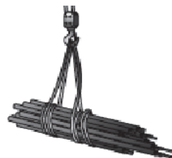
Carga mal acondicionada
