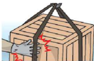
Entalamento/ esmagamento entre a carga e os elementos de elevação
